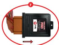
Com o chicote travado em seu alojamento, conecte-o ao módulo PRO 2.16 EN e empurre a alavanca novamente para travar o chicote no conector do módulo PRO 2.16 EN.
